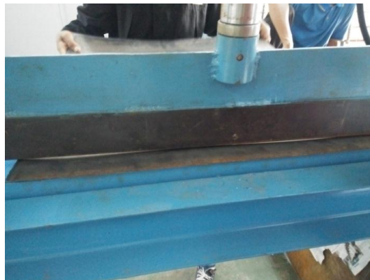
Gambar 4.20 Proses penekukan plat menggunakan punch dan die berbentuk v.
