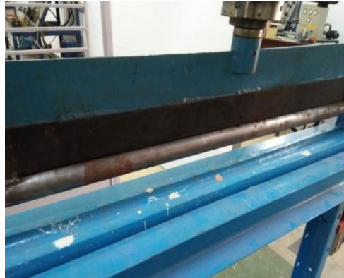
Gambar 4.19 Punch dan die berbentuk radius.
