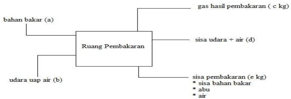
Gambar 2.14 Skema sistem penyaluran bahan bakar sampai menjadi gas buang Berat massa bahan yang masuk ruang pembakaran = berat massa bahan yang keluar.
