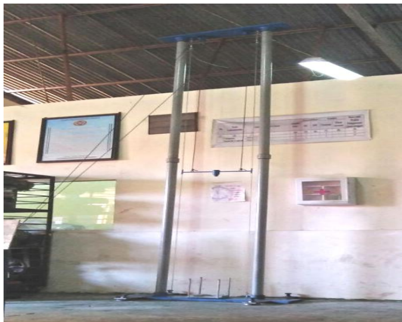
Gambar 3.12 Alat Uji Gerak Jatuh Bebas
