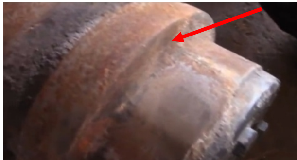
Gambar 3.14 Track roller yang rusak
