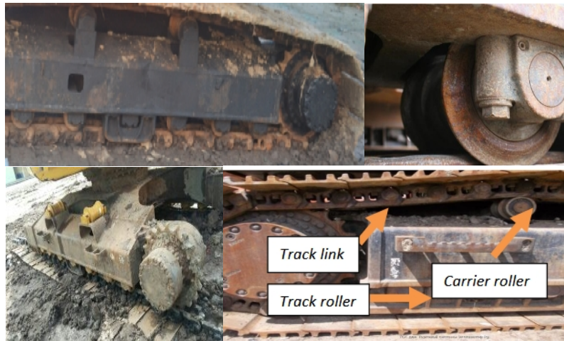
Gambar 3.12 track roller yang mengalami kerusakan
