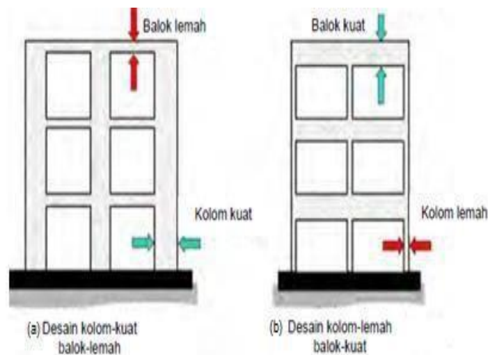
Gambar 2.6: Balok-kolom struktur beton bertulang.
