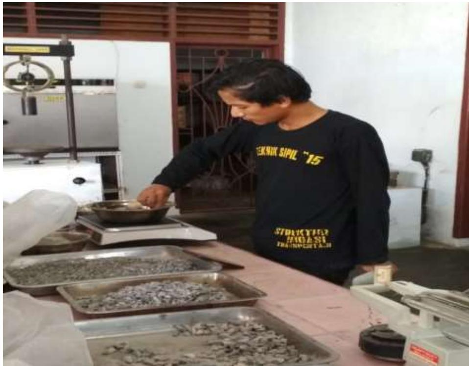
Gambar L4: Mencampur agregat halus, agregat kasar, Serat daun nanas sebelum dipanaskan dan dicampur dengan aspal.
