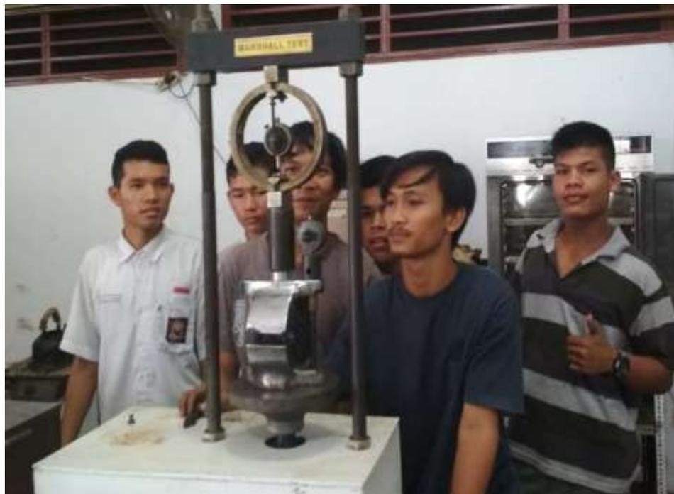
Gambar L10: Pengujian *Marshall Test*.
