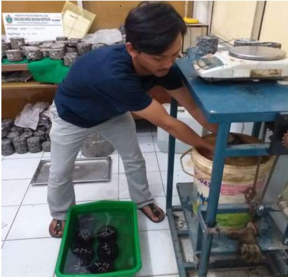
Gambar L7: Pengujian Bulk Density
