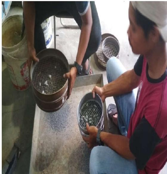
Gambar L6: Proses penyaringan agregat.
