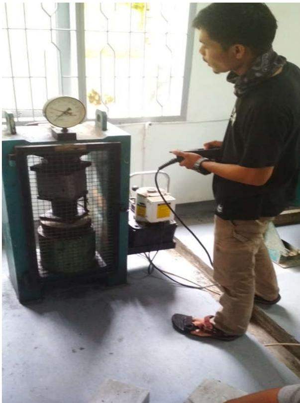
Gambar L14: Proses pengepresan benda uji.
