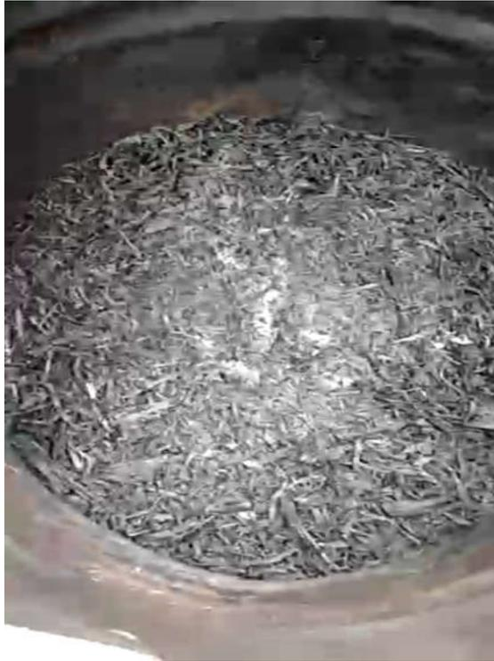
Gambar L9: Abu ampas tebu sebelum dilakukan penyaringan.
