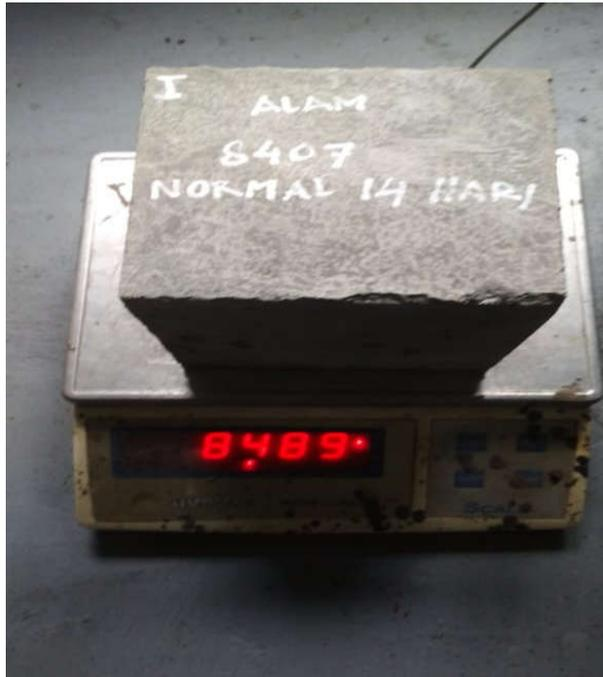
Gambar L13: Proses penimbangan benda uji.
