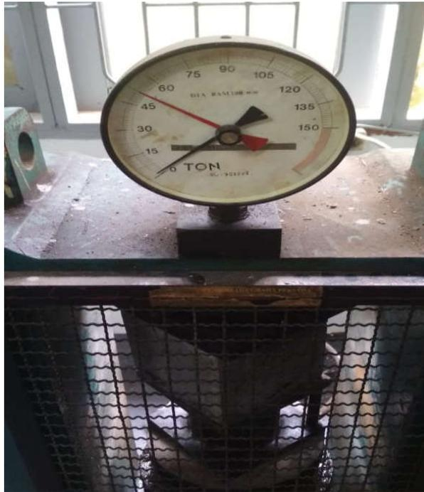
Gambar L15: Proses uji kuat tekan beton.
