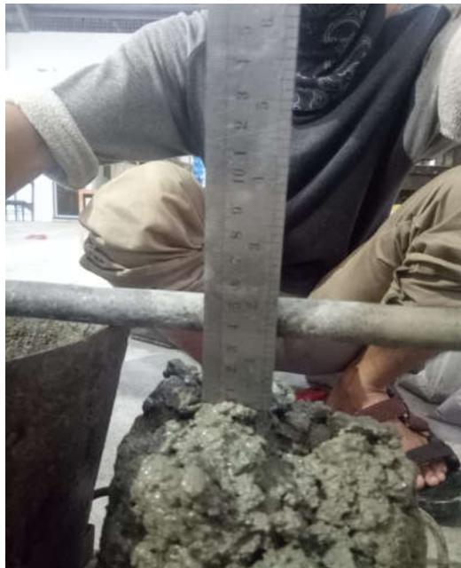
Gambar L10: Proses pengujian *slump*.
