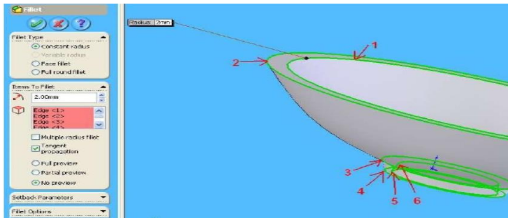
Gambar 3.7. gambar pengerjaan 3 pembuatan radius pada ujung mangkok
