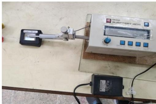
Gambar saat sedang melakukan pengujian kekasaran spesimen dengan menggunakan alat pengujian roughness test di Laboratorium Teknik Mesin Politeknik Teknologi Kimia Industri Medan.
