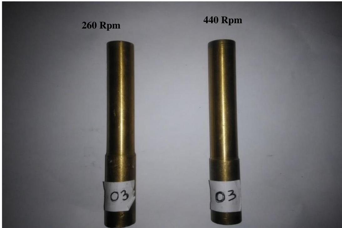
Gambar 4.5 Spesimen 0,3 mm kedalaman penggerindaan pada kecepatan putaran spindle 260 rpm dan 440 rpm
