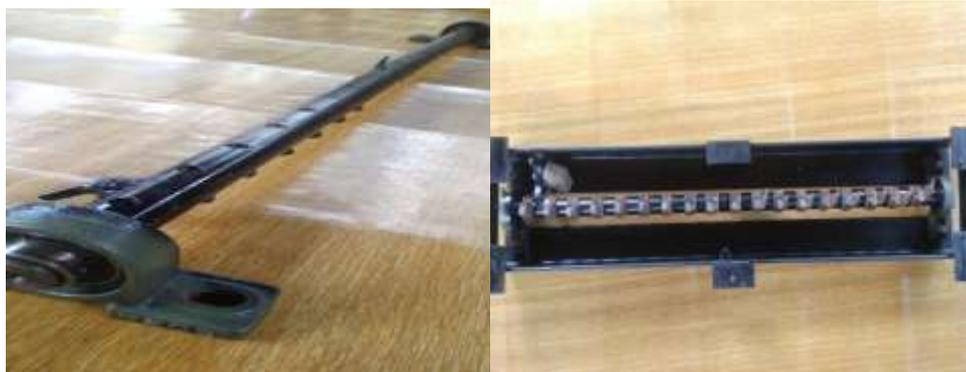
Gambar 4.16 Pemasangan Poros Dengan Rangka.
