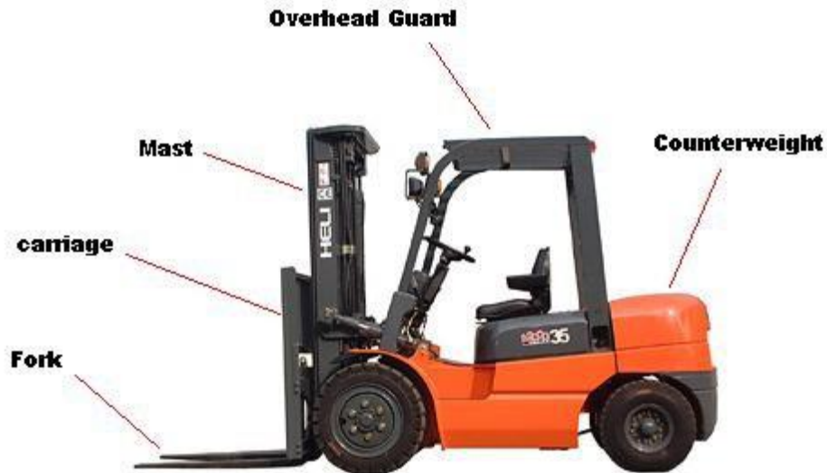
Gambar 2.1 Bagian-bagian utama forklift
