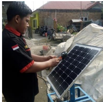
Gambar 3.31 Pengukuran Intensitas Radiasi Matahari
