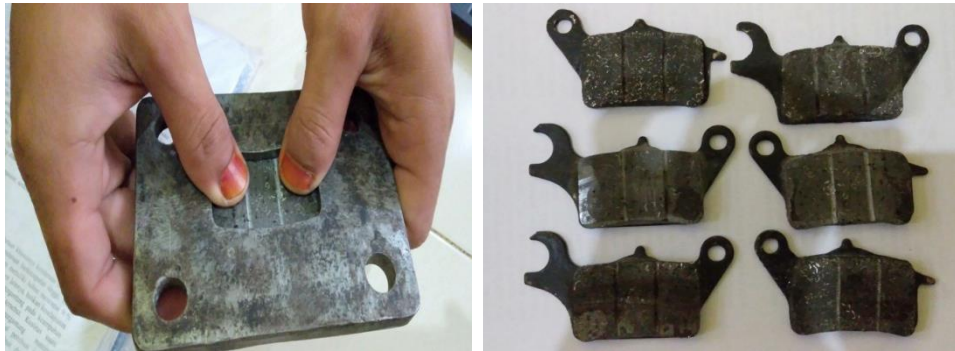
Gambar 2.26. Kampas Rem Selesai Proses Kompaksi
