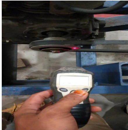
Gambar 3.30. Mengukur Rotasi Mesin Menggunakan Tachometer
