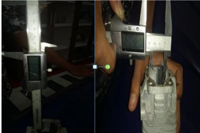
Gambar 3.2. Pengukuran Blok Dengan Jangka Sorong
