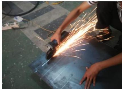
Gambar 3.7 Pemotongan pelat
