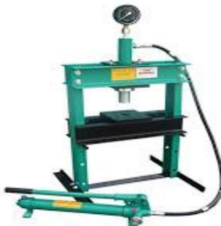
Gambar 2.1 Mesin pres tenaga hidrolik (Remora Savalas. 2016)
