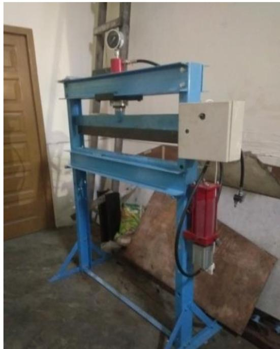
Gambar 3.2 Mesin pres hidrolik
