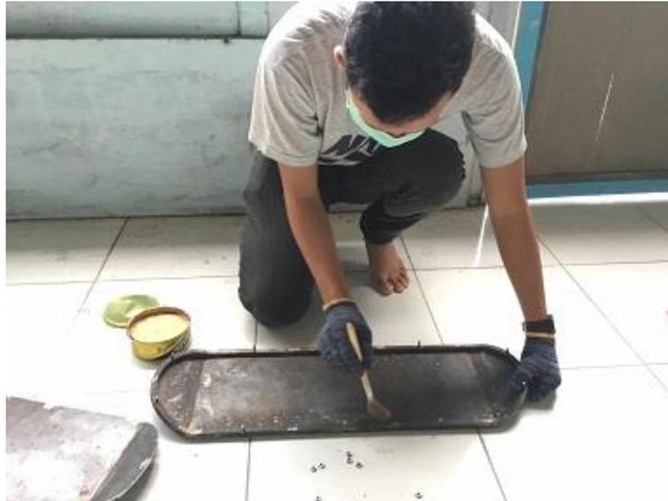
Gambar. 3.24 Mengoleskan mirror glaze (wax) pada cetakan
