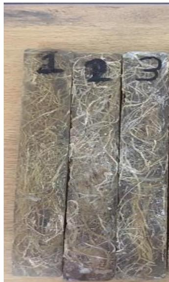
Gambar 4.1 Spesimen uji *Three Point Bending*
