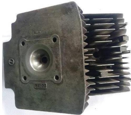
Gambar 2.7. *Cylinder Head* Sepeda Motor 2T
