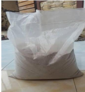
Gambar 3.2. Pasir cetak / pasir silica.
