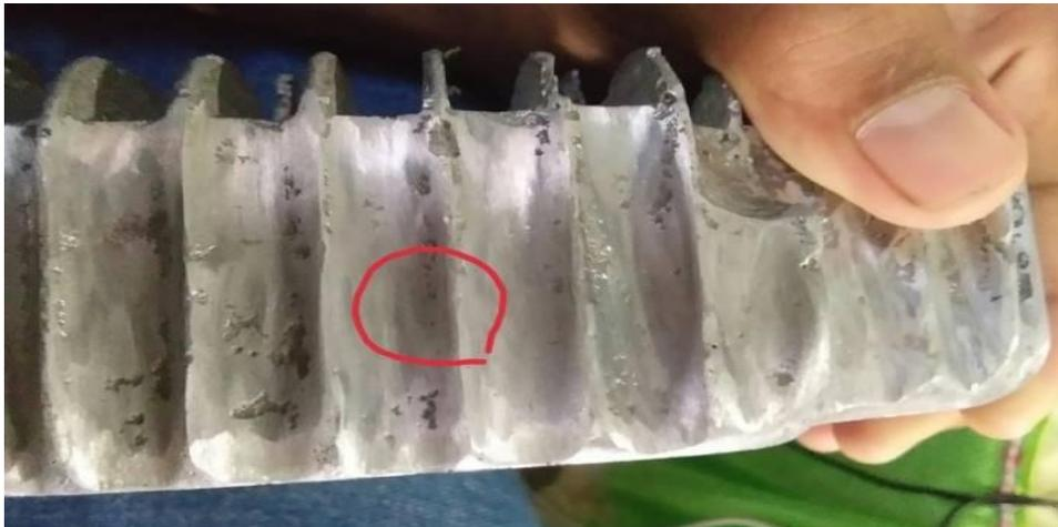
Gambar 4.8. Penampakan Cacat Lubang Jarum.
