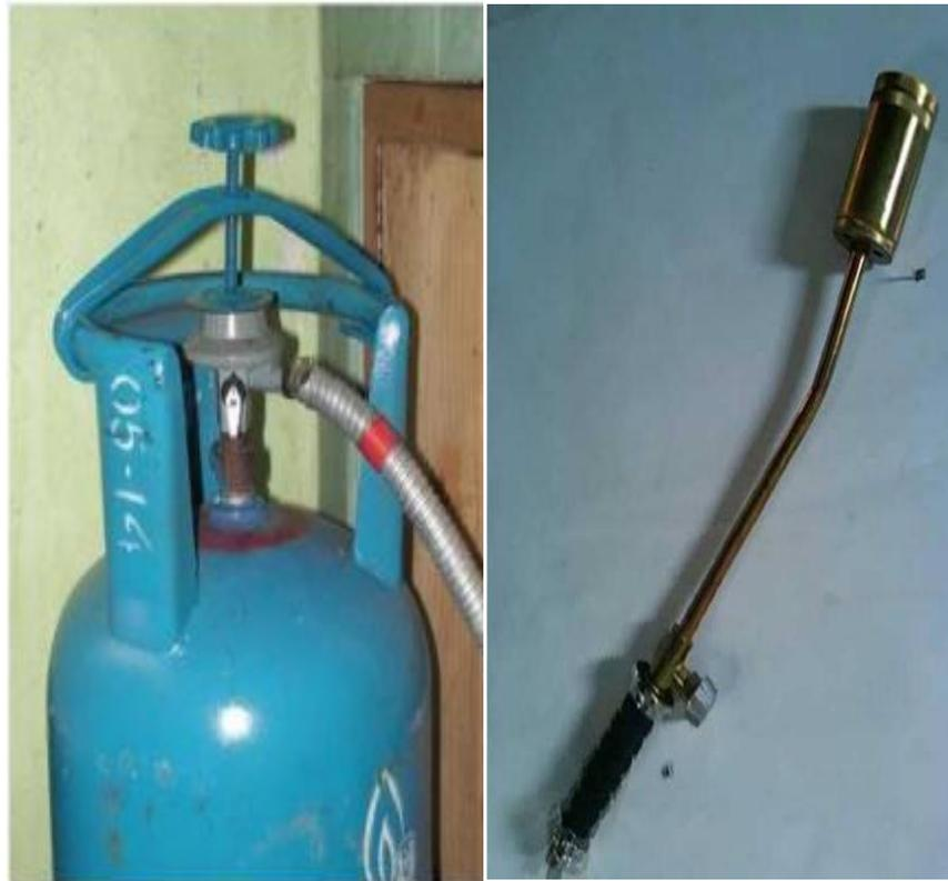
Gambar 4.1. Burner dan tabung gas LPG.
