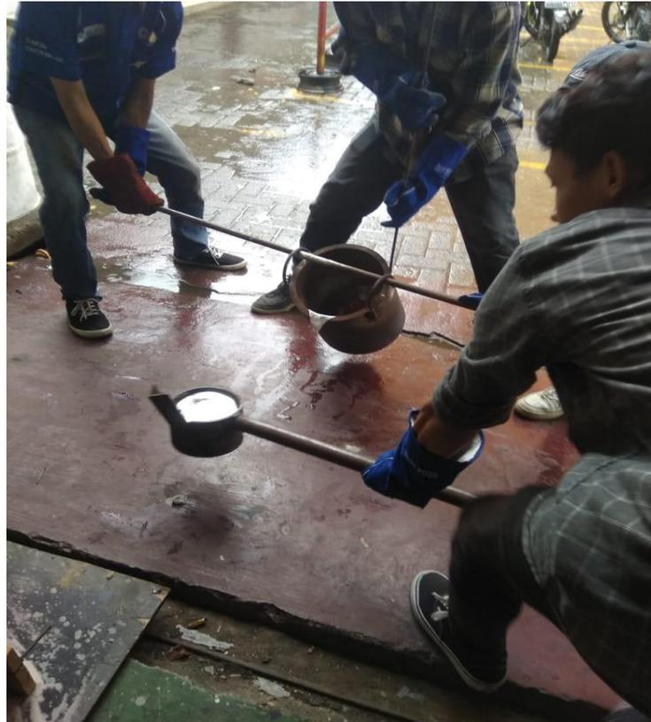
Gambar 4.18. Penuangan Aluminium yang telah dicairkan
