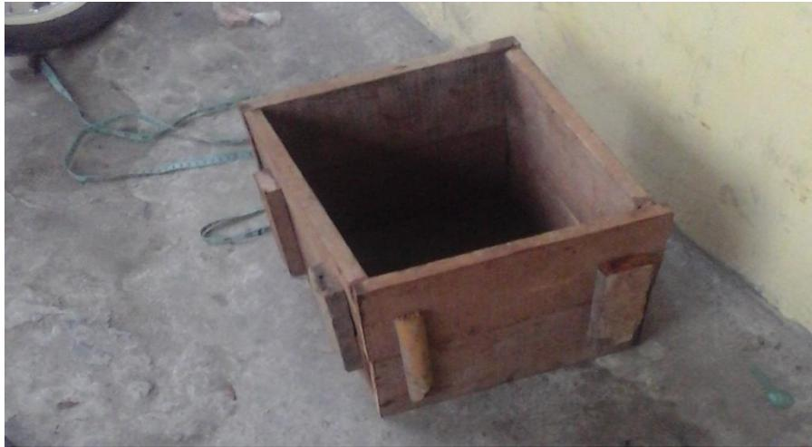
Gambar 3.6 Kotak Molding
