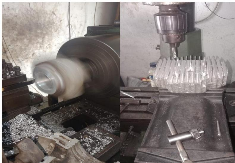
Gambar 4.20. Proses Penghalusan *Cylinder Head*
