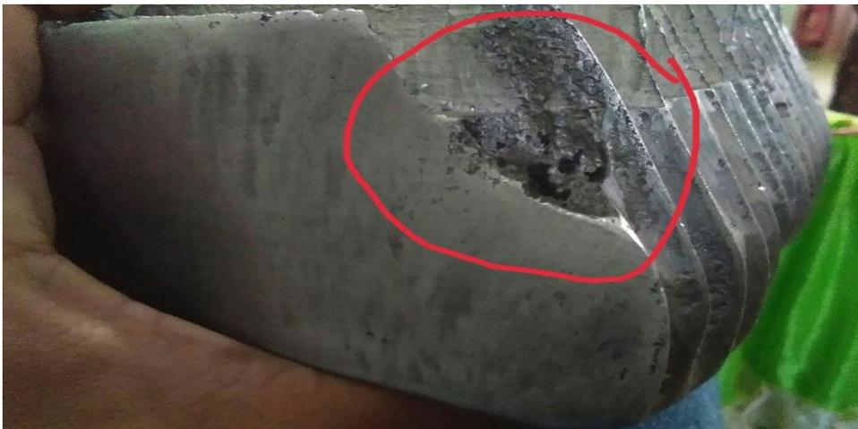
Gambar 4.12. Penampakan Cacat Rontokan Cetakan.
