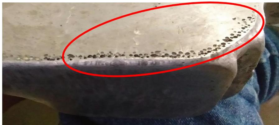
Gambar 4.6. Penampakan Cacat Rongga Udara.
