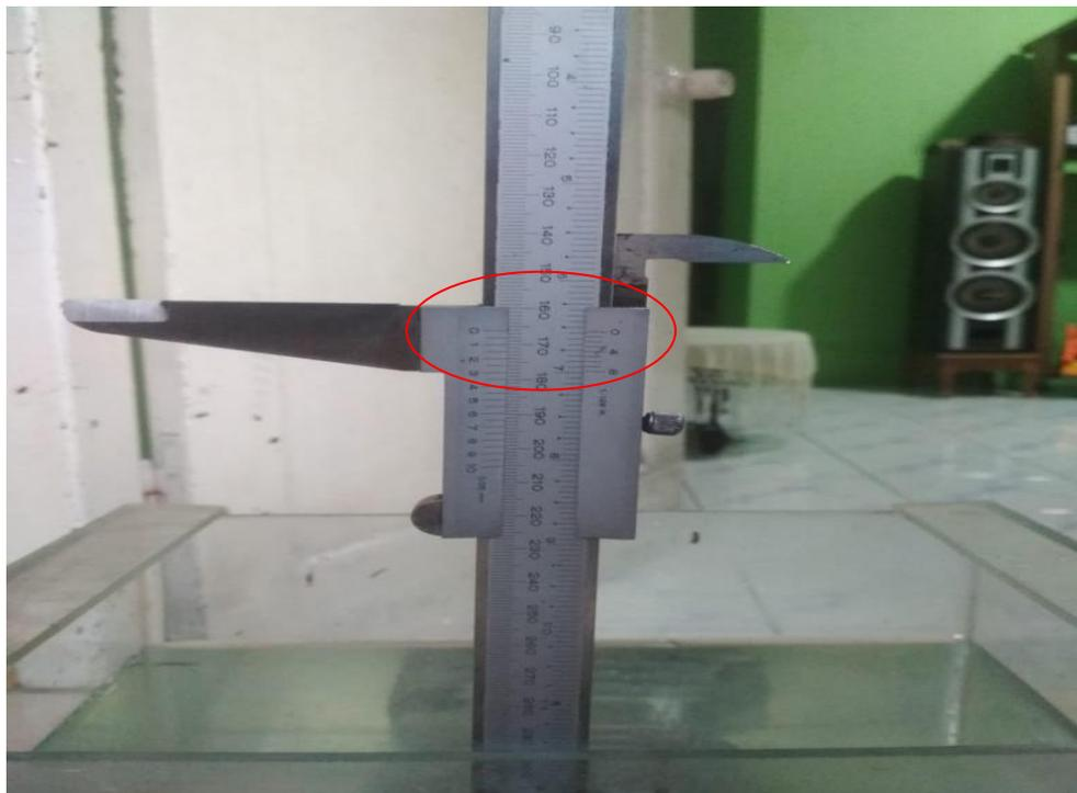
Gambar 4.3. Pengukuran *Cylinder Head* Dalam Air.
