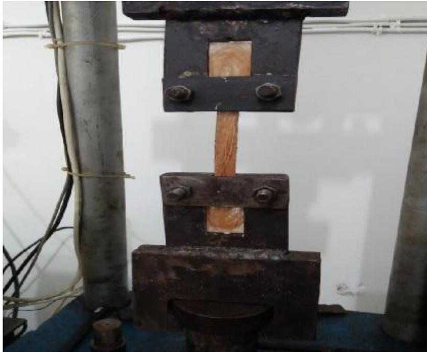
Gambar 4.15 Pemasangan benda uji
