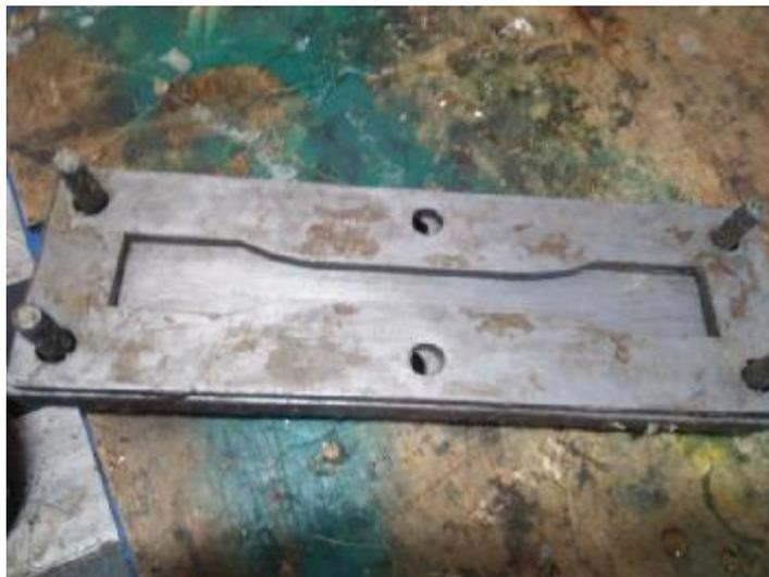
Gambar 3.12 Cetakan spesimen
