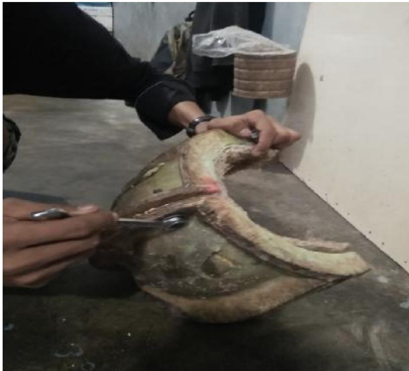
Gambar 4.9 Membuka baut cetakan
