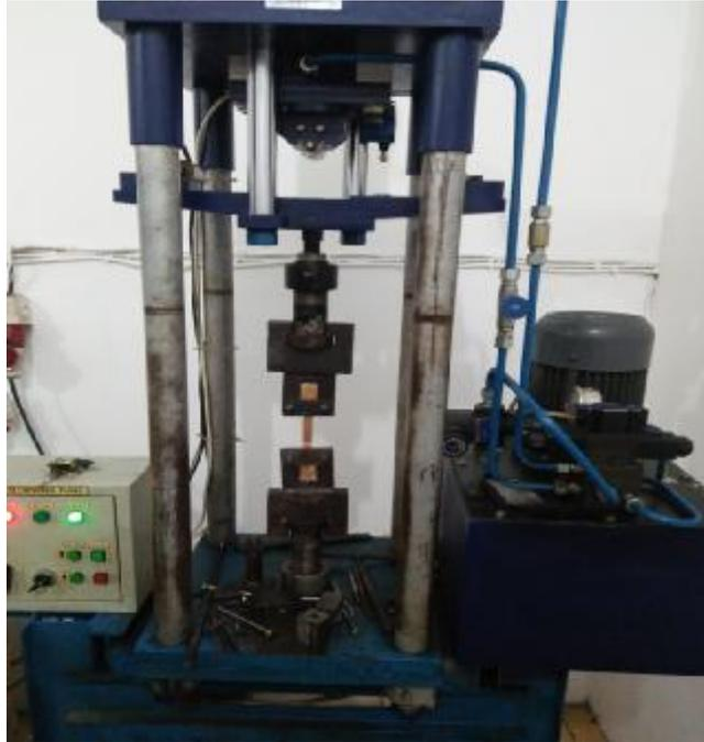
Gambar 3.13 Mesin uji tarik
