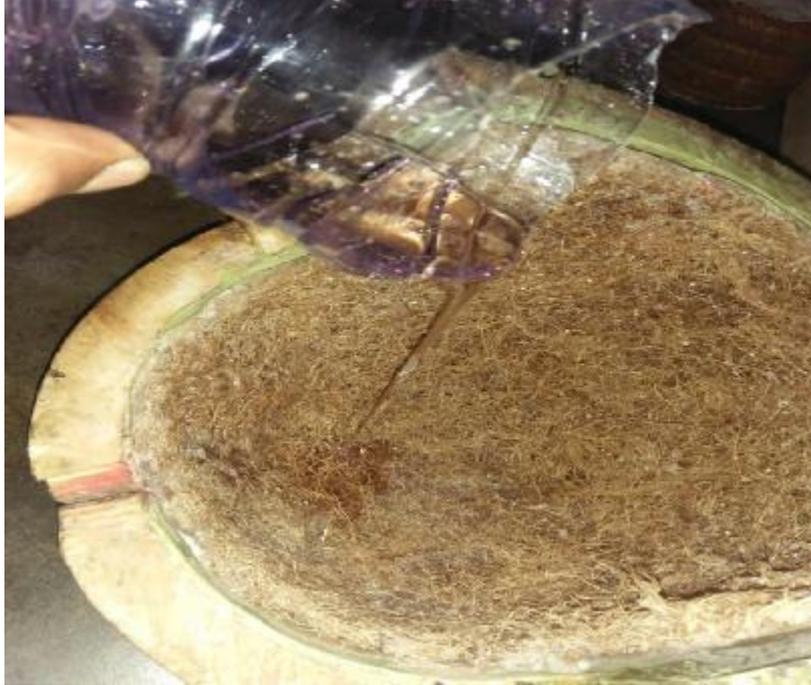
Gambar 4.8 Penuangan resin kedalam cetakan
