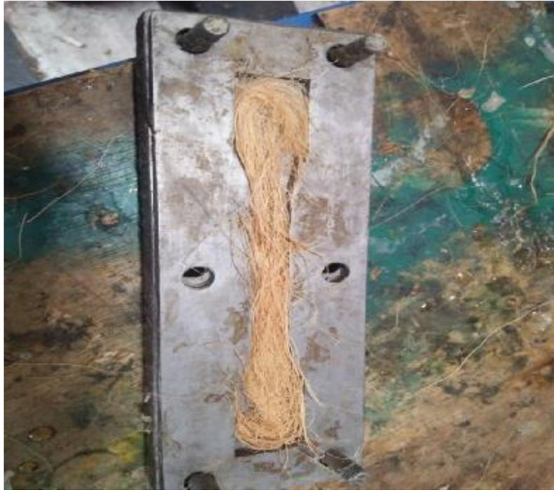
Gambar 4.13 Peletakan serat dan penuangan resin
