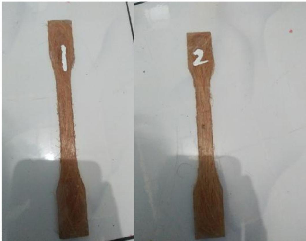
Gambar 4.19 Spesimen helm 1 dan 2
