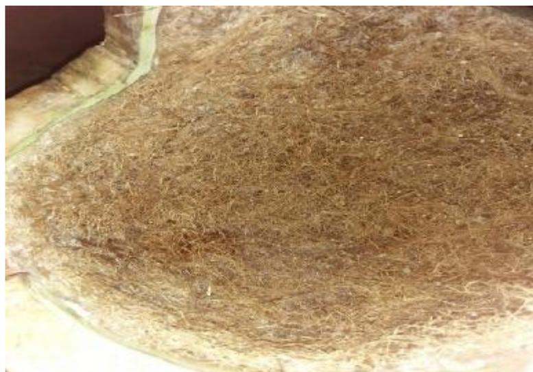
Gambar 4.7 Memasukkan serat kedalam cetakan
