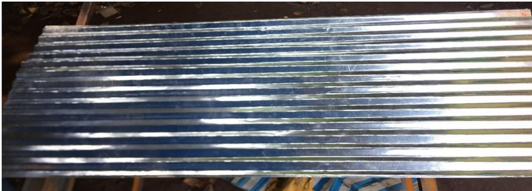
Gambar 4.7. Hasil Pembuatan Produk Genteng Bergelombang Dengan Panjang 180 cm, Lebar 80 cm dan Ketebalan Pelat 0,2 mm
