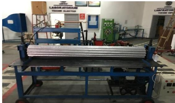
Gambar 4.1. mesin *roll sheet metal*
