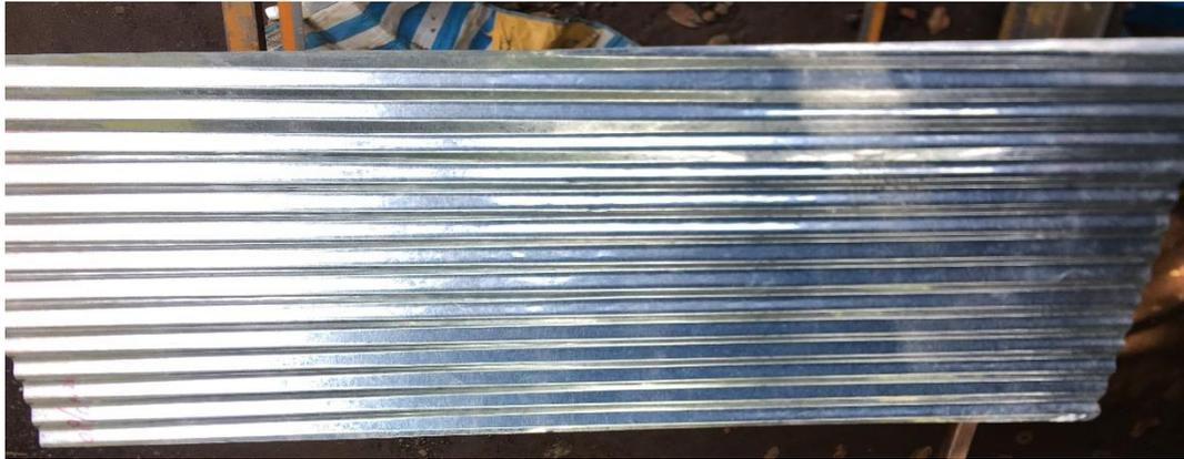
Gambar 4.8 Hasil Pembuatan Produk Genteng Bergelombang Dengan Panjang 180 cm, Lebar 80 cm dan Ketebalan Pelat 0,3 mm
