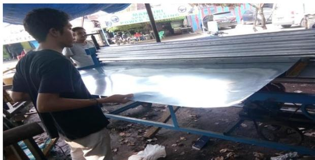
Gambar 4.5. Proses Memasukkan Pelat Kedalam *Roll*
