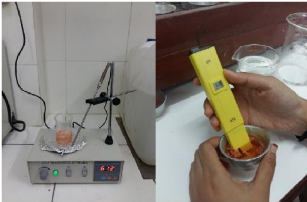
Gambar 36. Pengujian Derajat Keasaman (pH) (a) Pemanasan sampel; (b) Pengukuran pH
