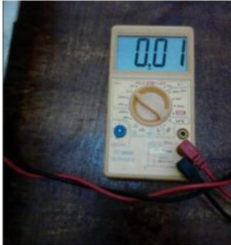
**Gambar 4.3 Pengujian Kondisi *Push Button Outlet* Tidak Ditekan**
