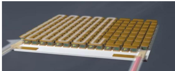
Gambar 2.1 Pergerakan Elektron Dari Bahan Tipe-p Ke Tipe -n
