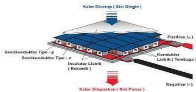
Gambar 2.2 Skema Elemen Peltier
