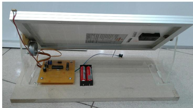
Gambar 4.2. foto rangkaian real alat tracking matahari. Tampak bawah.
