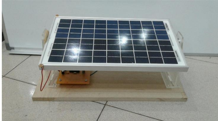
Gambar 4.1. Hasil foto rangkaian real alat tracking matahari. Tampak atas.
