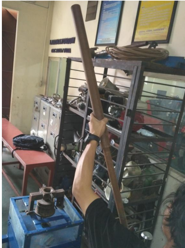
Gambar 3.19 Pemasangan Striker Bar
