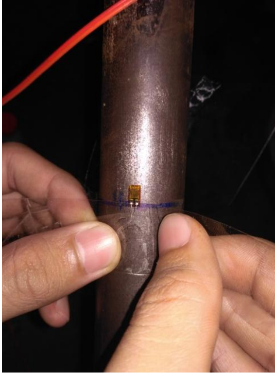
Gambar 3.11 Pemasangan Strain Gages
