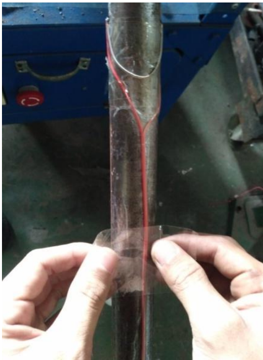
Gambar 3.14 Pemasangan Kabel Strain Gages
