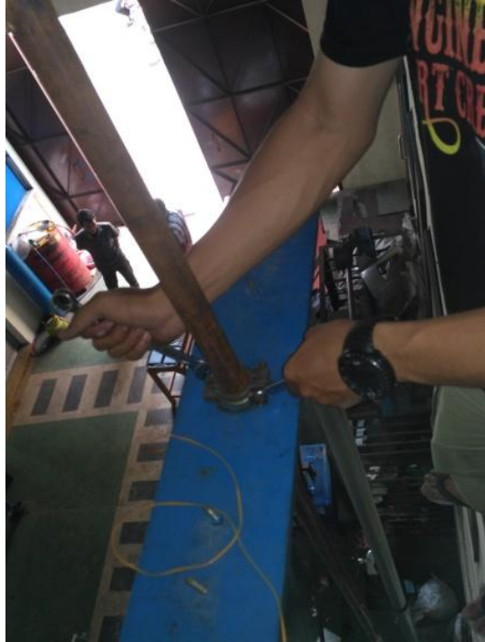
Gambar 3.13 Pemasangan klem besi
