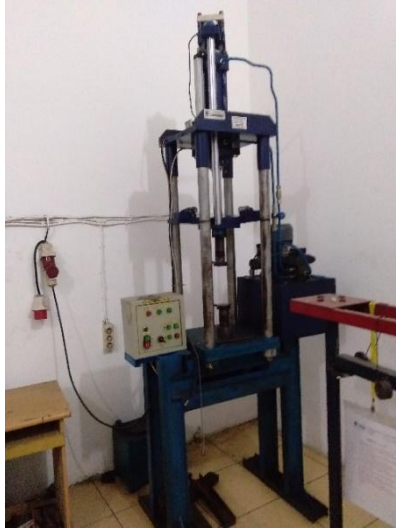
Gambar 4.8 Mesin Uji Tarik dan Kelengkapannya
