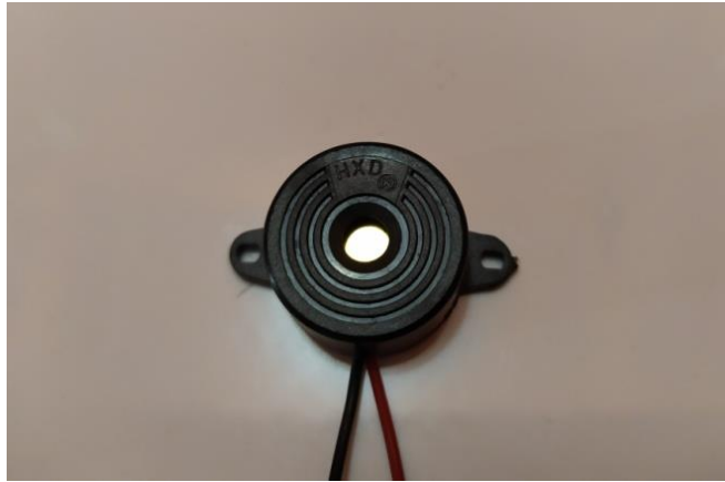
Gambar 2.13 Bentuk fisik Buzzer.
