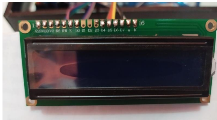
Gambar 2.6 bentuk fisik LCD 16x2.
