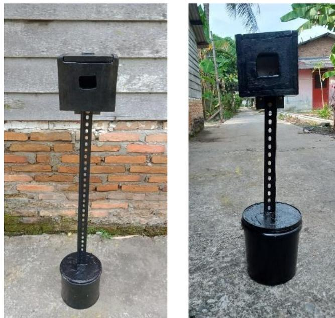
Gambar 4.11 Kotak untuk *rfid* sebelah kiri dan kotak untuk sensor *receiver* sebelah kanan
