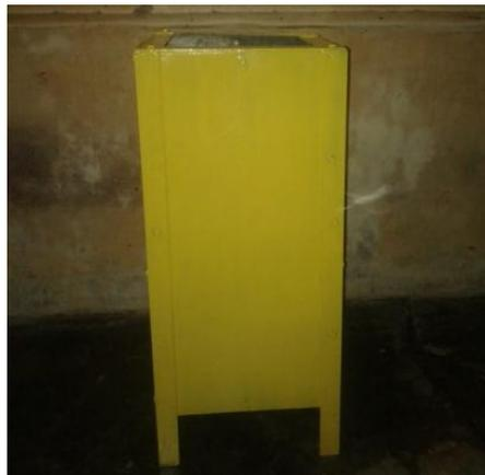
Gambar 4.6 Rangka Rumah untuk sistem kontrol *Traffic Spikes*
