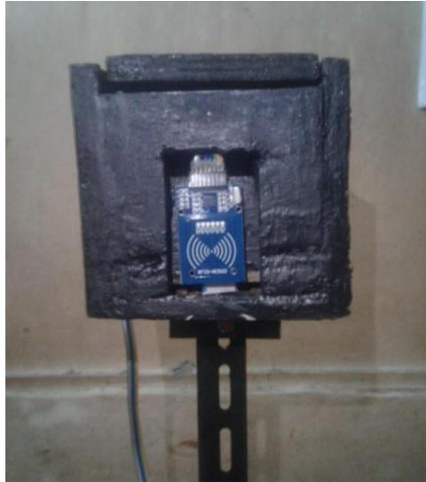
Gambar 4.20 Memasang *RF ID* dan *laser module* ke kotak
