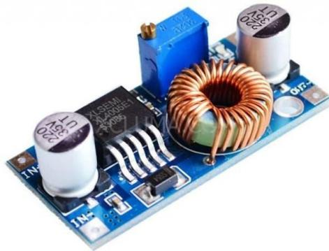
Gambar 3.11 *Step down dc-dc 5V*
