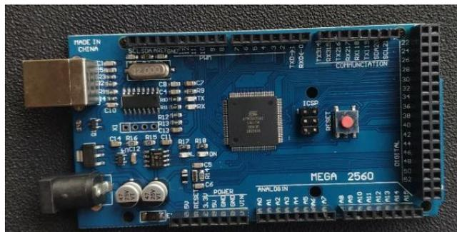
Gambar 3.9 *Arduino Mega 2560*
