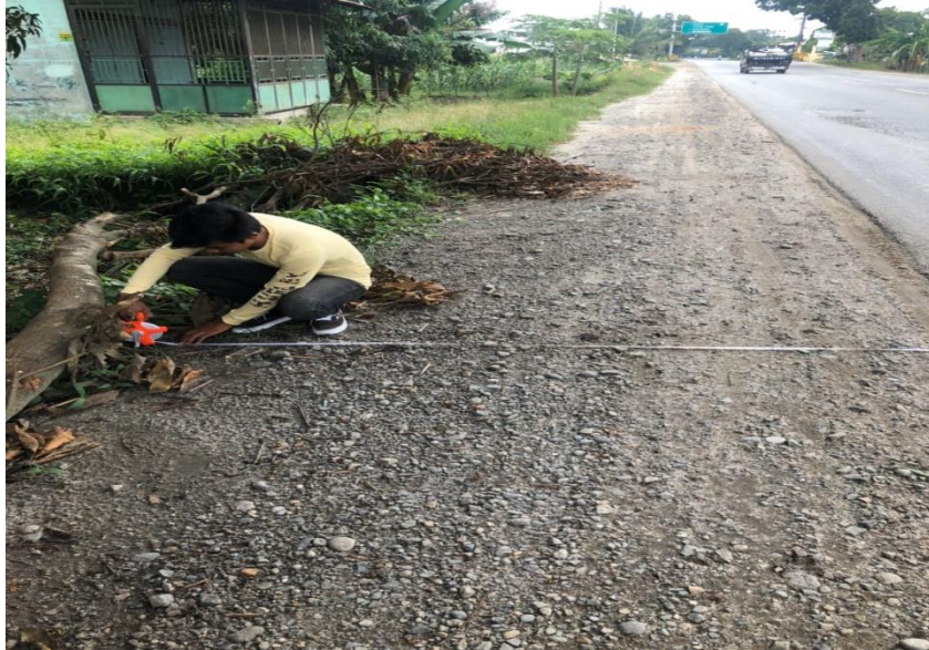
Gambar 5.1 :Dokumentasi pengukuran bahu jalan pada lokasi survey
