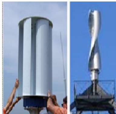
Gambar 2.3 Rotor tipe U dan Heliks (Admadi, S. 2008)
