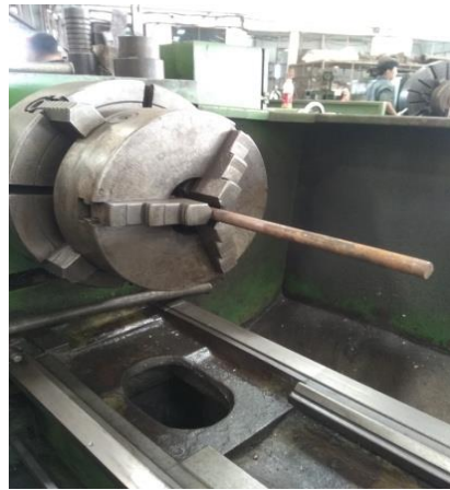
Gambar 4.4 proses pembubutan poros.
