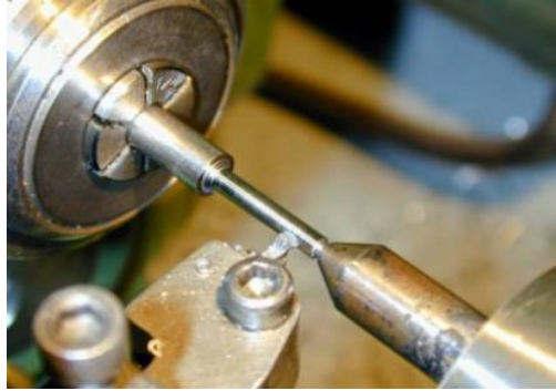
Gambar 4.6 proses pembubutan poros.
