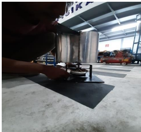
Gambar 4.16 merakit benda kerja pulley dengan sudu type – U
