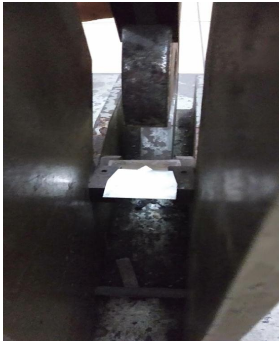
Gambar 3.23 Meletakkan benda uji pada alat uji impact
