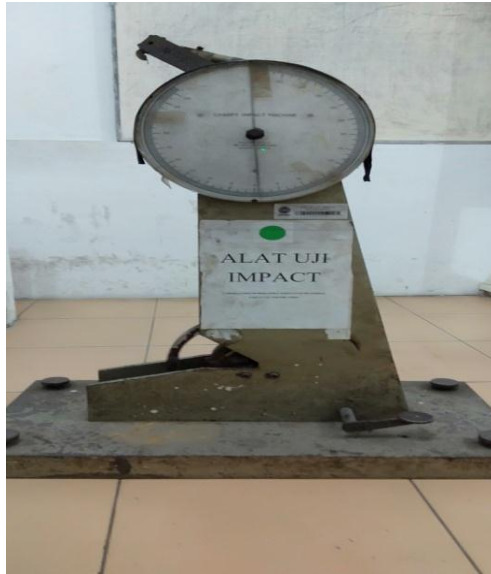
Gambar 3.22 Menyetel jarum skala dalam posisi 0
