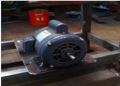
Gambar 3.2 Motor Induksi 1 fasa
