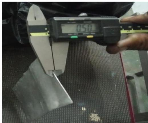
Gambar 4.8 Tebal Aluminium 0,5 mm
