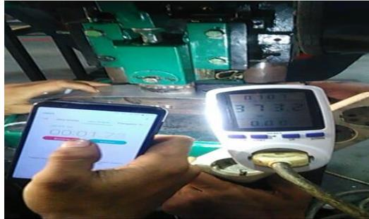
2. Kecepatan hentakan pada aluminium 0,5 mm dengan menggunakan alat voltmeter.
