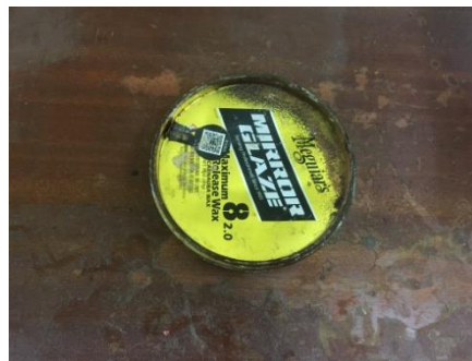
Gambar 3.14 mirror glaze sebagai pelapis cetakan
