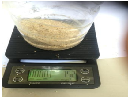
Gambar 3.13 serat sekam padi yang sudah siap di gunakan
