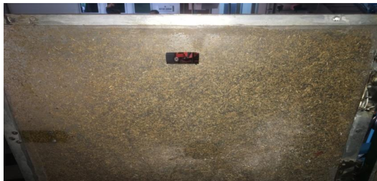
Gambar 3.19 perekatan dinding komposit dengan paku rivet dan pembuatan lobang untuk dudukan sensor
