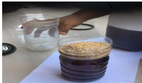
Gambar 3.16 Pencampuran resin + sekam padi + catalis
