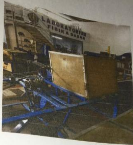
Foto Kabin komposit dengan berbagai macam variasi 0 %, 10 %, 20 %, 30% dengan di perkuat sekam padi
