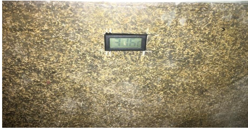
Gambar 3.20 Pemasangan thermo sensor pada dinding komposit
