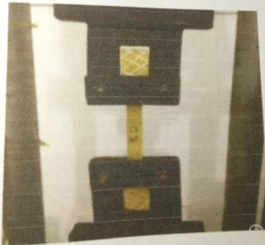
Foto Pengujian tarik komposit variasi 0 % dengan mesin uji tarik astrmd368 milik Fakultas Teknik, Universitas Muhammadiyah Sumatera Utara
