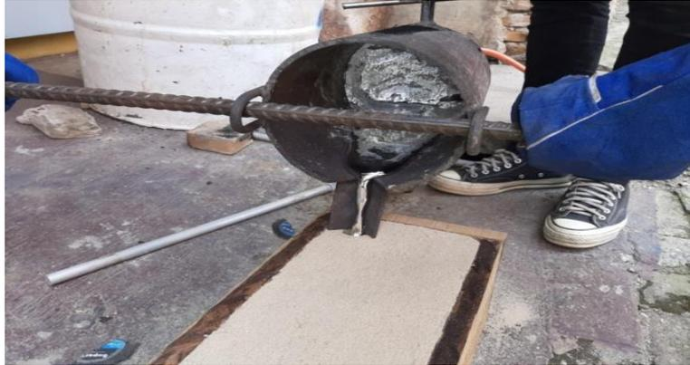
Gambar 3.15. Menuangkan Logam Alumunium
