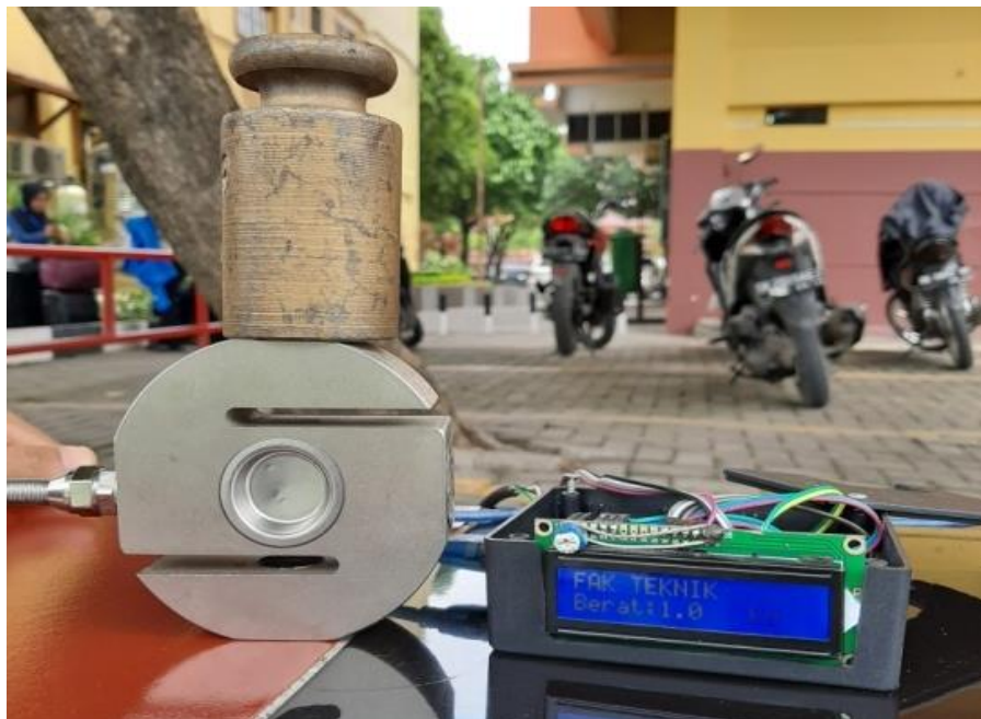
Gambar kalibrasi menggunakan timbangan load cell
