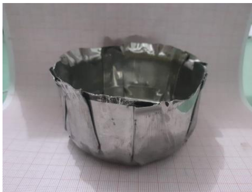
Gambar 4.12 Hasil uji tekan pada spesimen 4 kedalaman 30 mm tebal 0,5 mm
