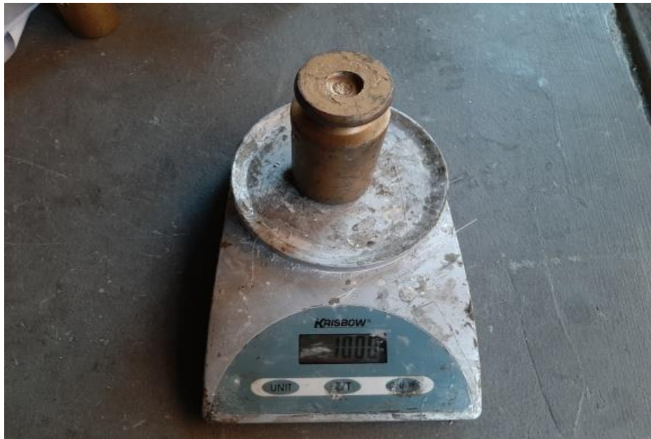
Gambar kalibrasi menggunakan timbangan load cell
