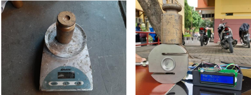
Gambar 4.3 Kalibrasi Menggunakan Timbangan Analog
