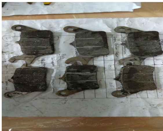
Gambar 4.68. Kampas Rem Serbuk Tempurung Kelapa
