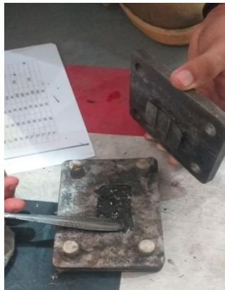
Gambar 4.23. meratakan adonan pada cetakan
