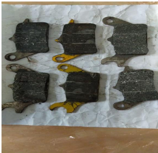
Gambar 4.70. Kampas Rem Serbuk Serbuk Aluminium
