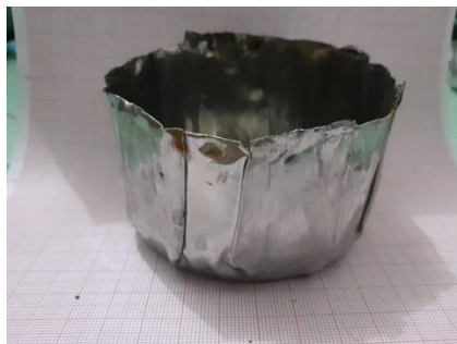
Gambar 4.24 Hasil uji tekan pada spesimen 12 kedalaman 20 mm tebal 0,4 mm
