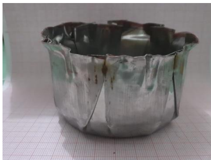
Gambar 4.23 Hasil uji tekan pada spesimen 11 kedalaman 40 mm tebal 0,4 mm
