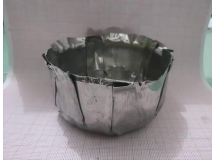
Gambar 4.21 Hasil uji tekan pada spesimen 9 kedalaman 30 mm tebal 0,4 mm
