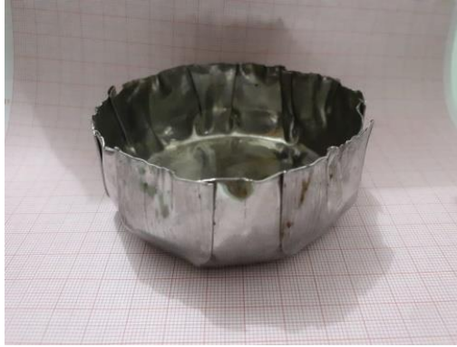
Gambar 4.13 Hasil uji tekan pada spesimen 1 kedalaman 20 mm tebal 0,3 mm
