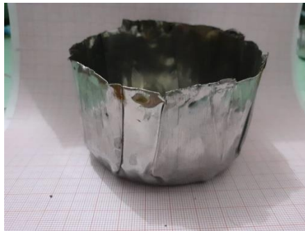
Gambar 4.18 Hasil uji tekan pada spesimen 6 kedalaman 40 mm tebal 0,3 mm
