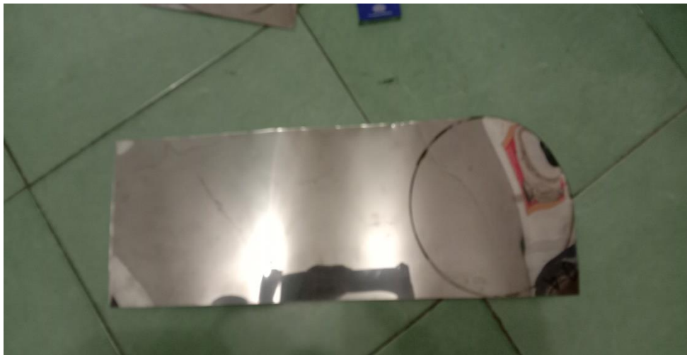
Gambar 3.7. Pelat stainless steel tebal 0,4 mm
