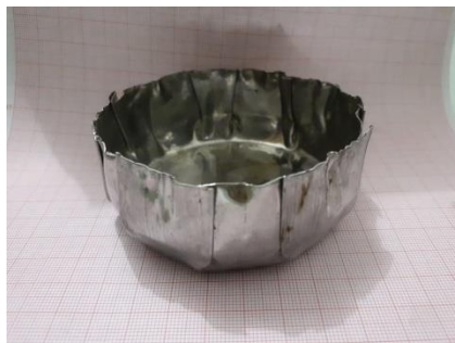
Gambar 4.20 Hasil uji tekan pada spesimen 8 kedalaman 20 mm tebal 0,4 mm
