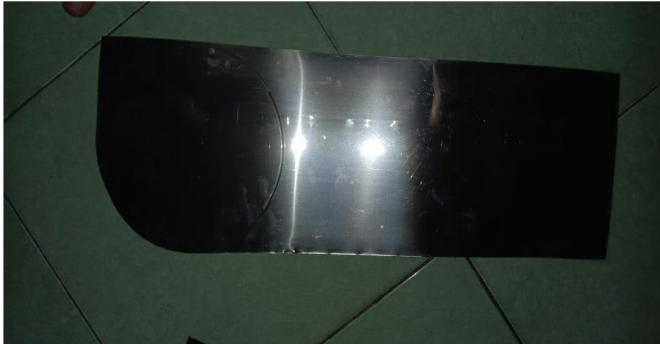
Gambar 3.6. Pelat stainless steel tebal 0,3 mm
