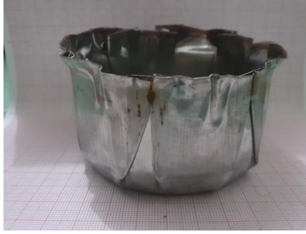
Gambar 4.17 Hasil uji tekan pada spesimen 5 kedalaman 40 mm tebal 0,3 mm
