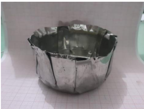
Gambar 4.16 Hasil uji tekan pada spesimen 4 kedalaman 30 mm tebal 0,3 mm
