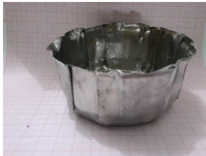
Gambar 4.22 Hasil uji tekan pada spesimen 10 kedalaman 30 mm tebal 0,4 mm
