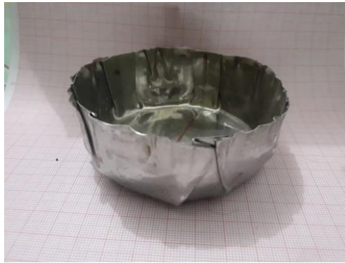
Gambar 4.14 Hasil uji tekan pada spesimen 2 kedalaman 20 mm tebal 0,3 mm
