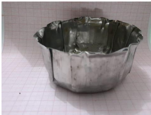
Gambar 4.15 Hasil uji tekan pada spesimen 3 kedalaman 30 mm tebal 0,3 mm
