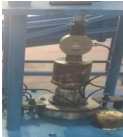
Gambar 3.9. Pemasangan Load cell
