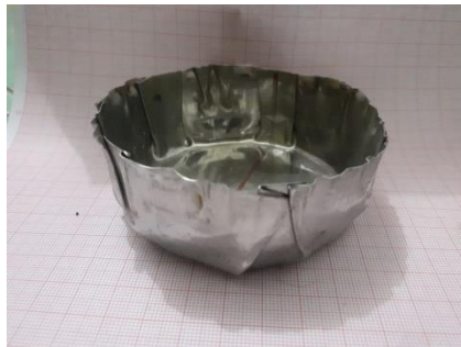
Gambar 4.19 Hasil uji tekan pada spesimen 7 kedalaman 20 mm tebal 0,4 mm
