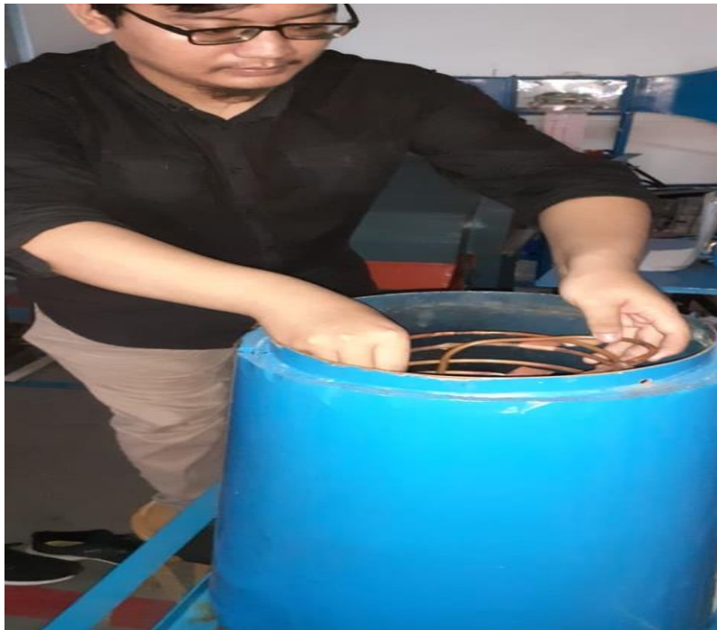
Gambar 4.11 Pemasangan Helical Coil Kedalam Tangki
