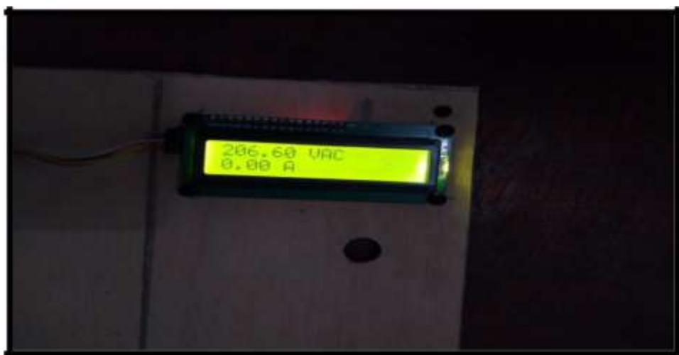
Gambar 4.8 Sensor PZEM-004T sebelum diberi beban
