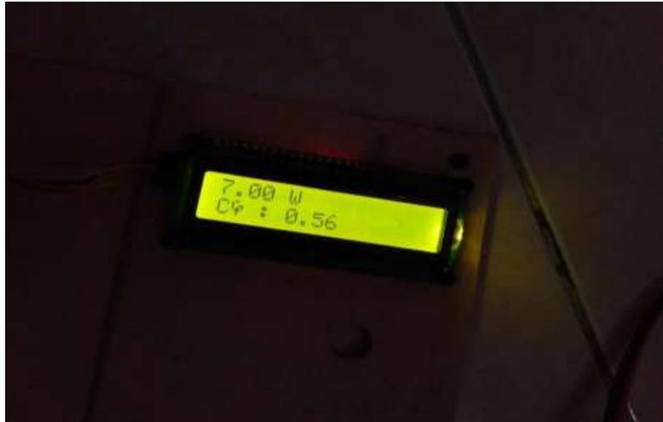
Gambar 4.12 Cos phi dan daya RMS sensor PZEM-004T
