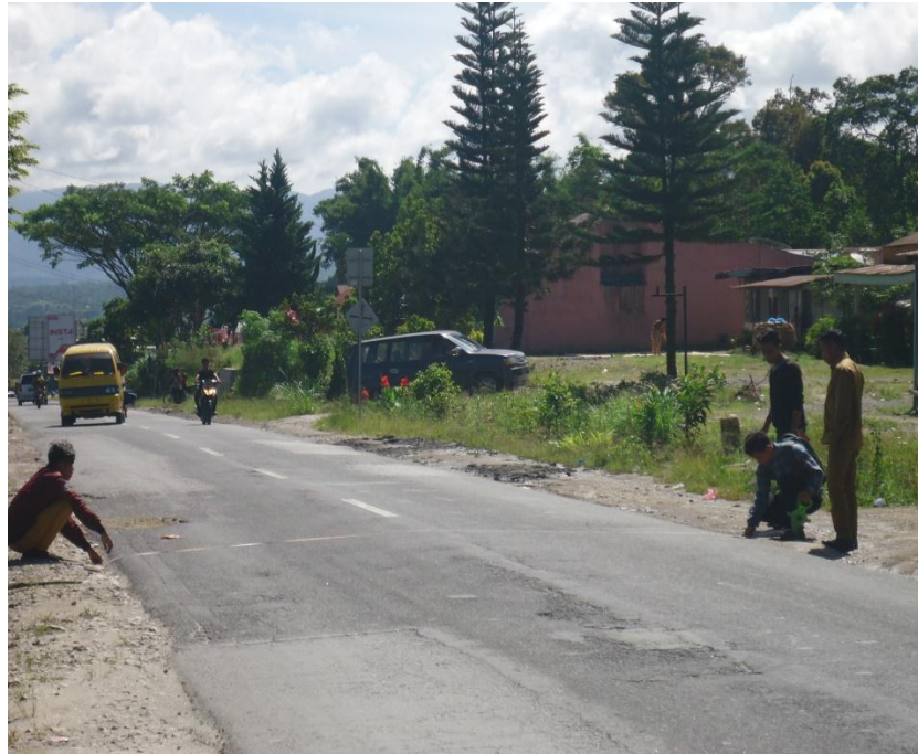
Gambar L 3: Mengukur lebar Jalan Lintas Barat Sumatera Utara Sitinjo – Sidikalang STA 00+000 – 02+000.
