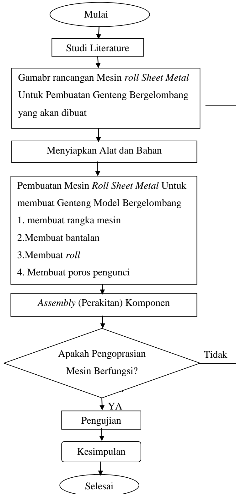
Gambar. 3. 27. Diagram alir proses pembuatan mesin roll sheet metal model bergelombang
