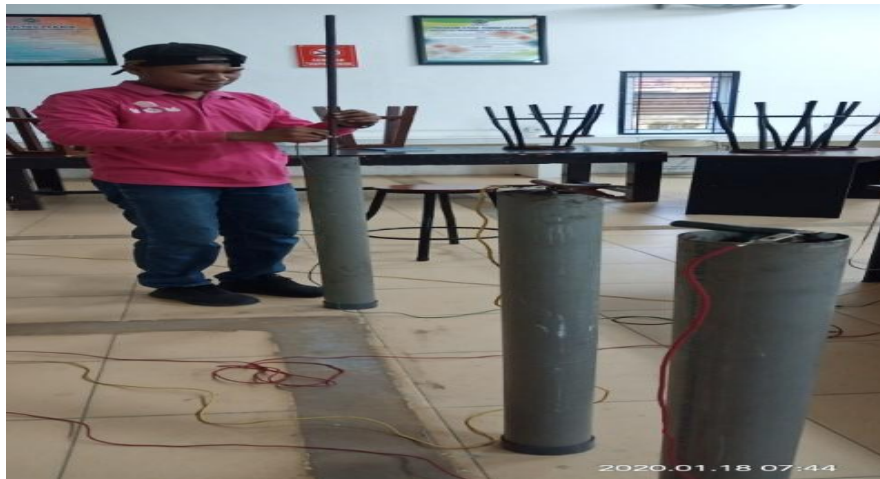
Gambar 3.1 rancangan alat dengan metode tiga titik secara paralel
