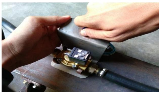
Gambar 3.23Pemasangan tombol switch
