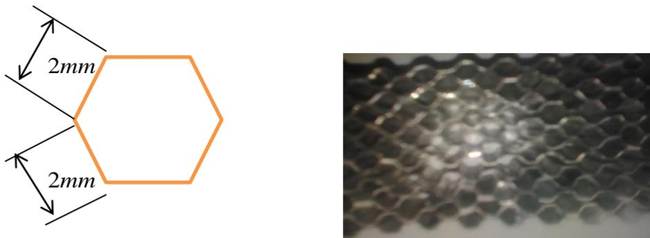
Gambar 3.11 Spesimen Sarang Lebah Diameter 2 mm
