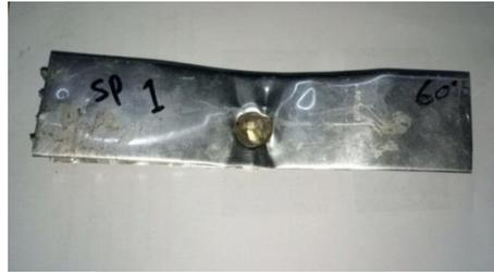
Gambar 4.6 hasil Spesimen setelah di uji dengan sudut miring 60° drajat
