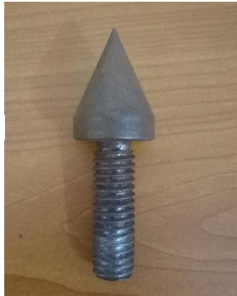
Gambar 4.1 proyektil tajam diameter 22,3 mm
