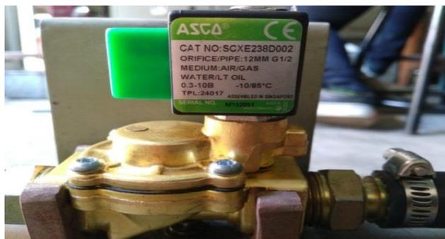
Gambar 3.22Pemasangan solenoid
