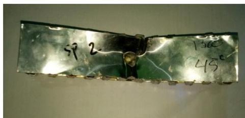
Gambar 4.8 hasil Spesimen setelah di uji dengan sudut miring 45 drajat
