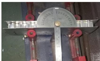
Gambar 4.3 pengukuran sudut normal 90 drajat sebelum di uji
