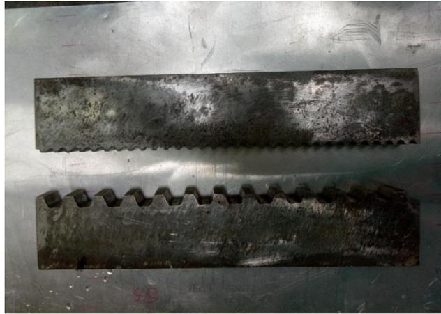
Gambar 3.3 Cetakan Spesimen Struktur Sarang Lebah
