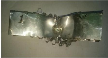
Gambar 4.4 hasil Spesimen setelah di uji dengan sudut normal 90 drajat
