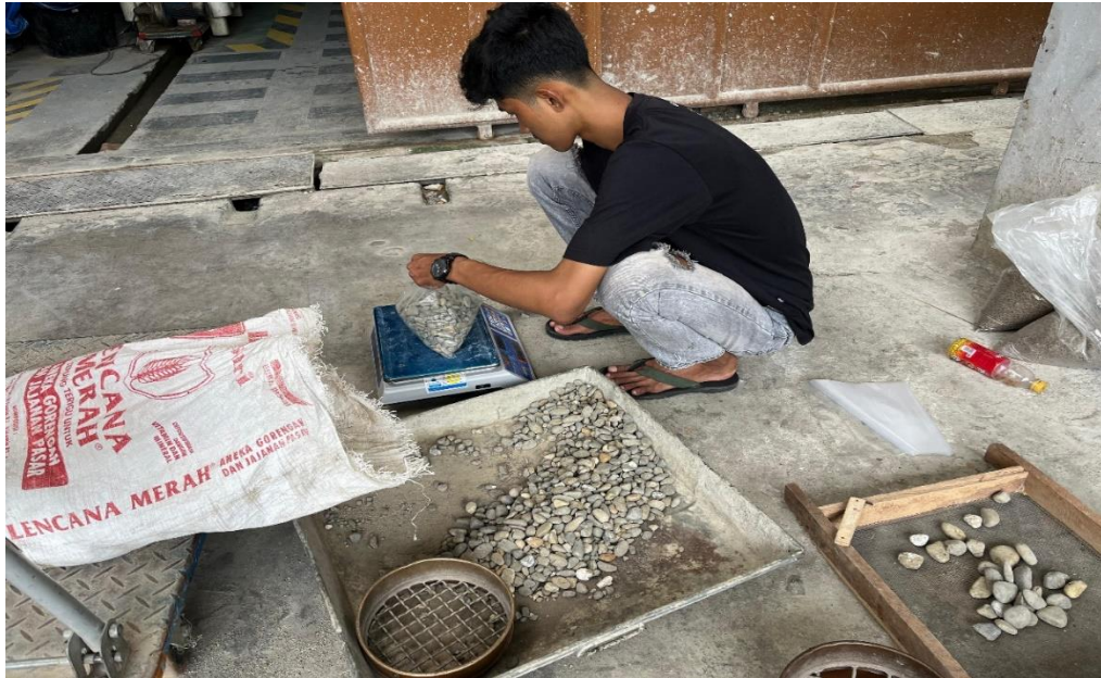
Gambar L3: Menimbang agregat kasar
