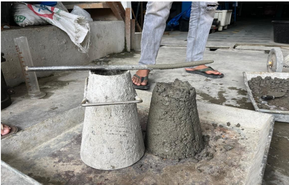
Gambar L4: Mengukur tinggi slump
