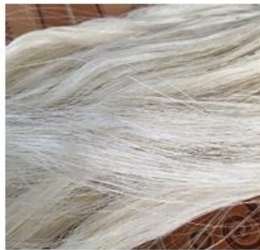
Serat agave sisalana untuk campuran beton
