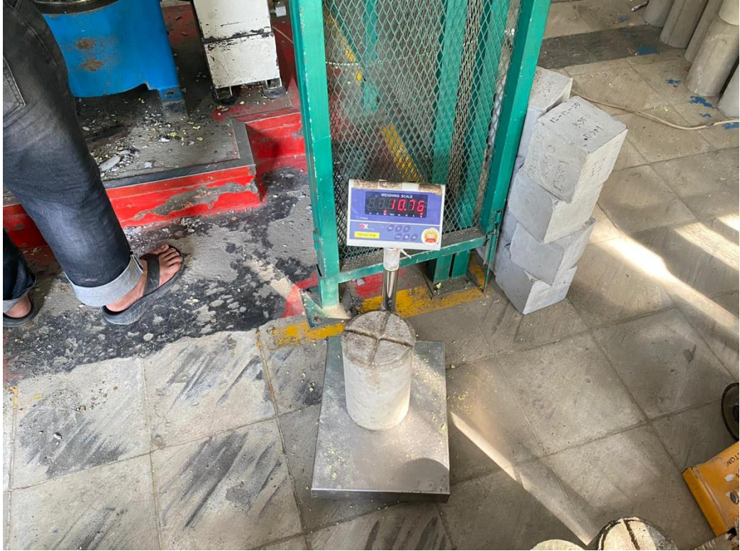
Gambar L7: Menimbang benda uji
