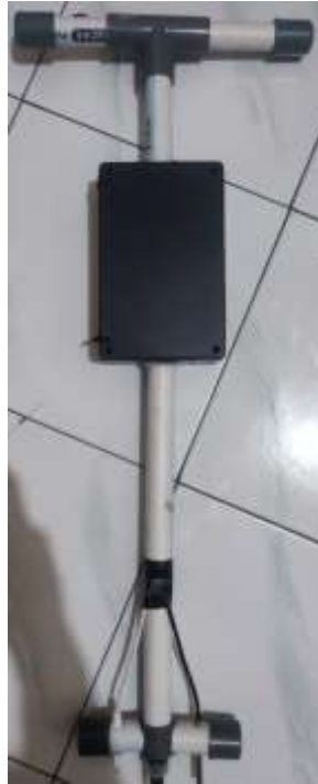
Gambar 4. 1 Implementasi Fisik Prototipe Detektor Mutu Lateks Portabel Berbasis IoT
