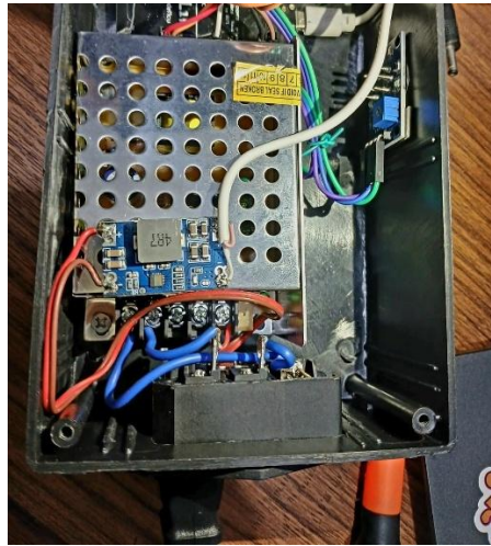
Gambar 4.2 Sistem Catu Daya dan Stabilitas Elektrik
