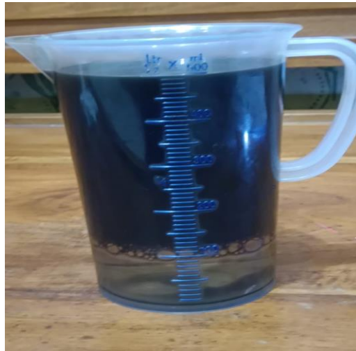
Gambar. 9 Hasil pemisahan minyak dan air oleh oil skimmer kapasitas 10 L
