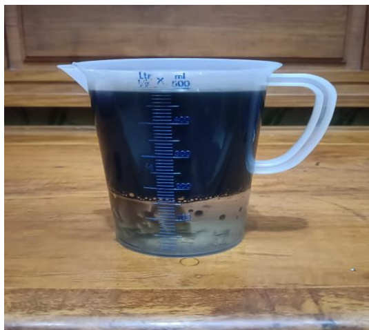
Gambar 10 Hasil pemisahan minyak dan air oleh oil skimmer kapasitas 15 L
