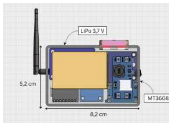
Gambar 3.4 Perancangan Prototipe tampak belakang
