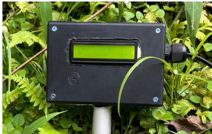
Gambar 4.6 Tampilan LCD pada kondisi Aman
