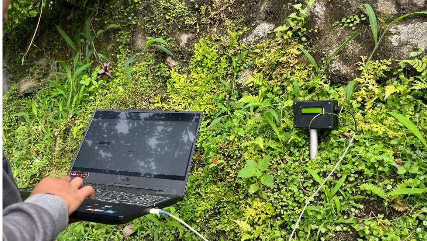
Gambar 4.5 Proses pengujian pembacaan sensor MPU6050
