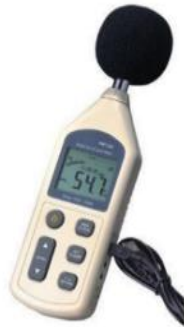
Gambar 2.5:Alat pengukur kebisingan jalan (Sound Level Meter)
